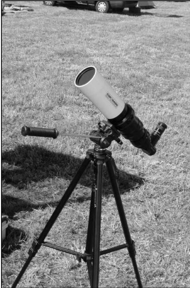
Afbeelding 2 De Helios-1 protuberansen kijker.
